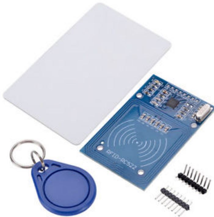
Figura 5. No sentido horário: TAG cartão, MFRC522, Trilho e TAG chaveiro.
